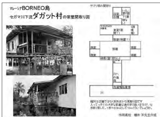
①ダガット村の高床式の家々の平均的な間取り （市岡高等学校 櫻井洋先生作成・写真も共有化写真より）
