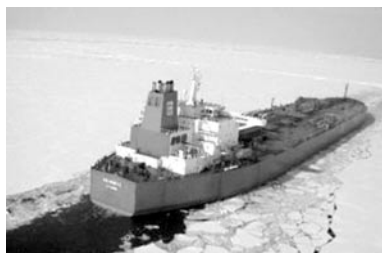
試験航海中の耐氷型タンカー (写真はいずれもS-1ホームページから引用)
