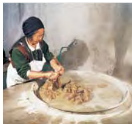
8 洗濯 織りあがった反物を灰汁で煮立てる。そのあと二人で布を引っぱって布目を整える。
