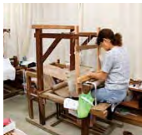
7 織り 芭蕉糸は乾燥すると切れるので、水に浸したり、霧吹きで湿気を与えながら織る。
