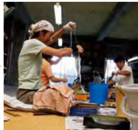
3 芋引き 皮から繊維を取り出す。エービと呼ばれる竹ばさみでしごく。
