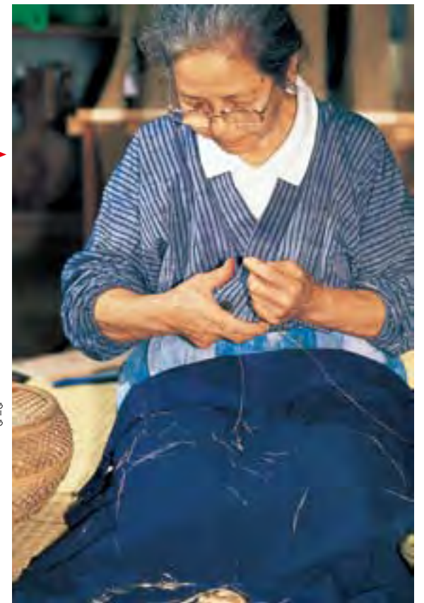
4 芋績み 小刀で繊維を裂き糸をつないでいく。反物の仕上がりをする右側とも時間のかかる作業。
