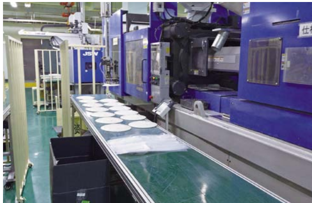
LEDシーリングライトのカバー部分の射出成形
