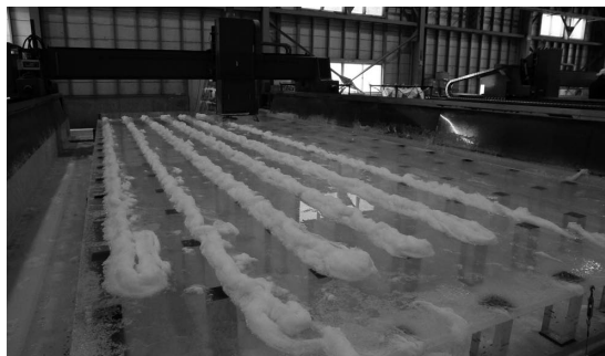
アクリルパネルを削る（1枚のパネルの厚さを均一にするのに1日かかる）
