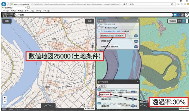
図4 2画面表示(右 陰影起伏図+土地条件図透過率30%)
