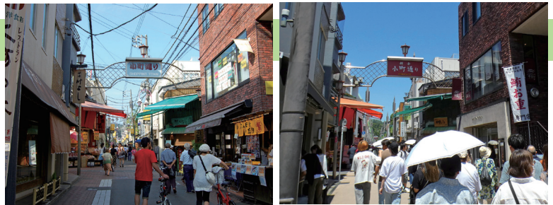
写真1 小町通りの電線地下埋設の様子 (左:2009年、右:2024年ともに筆者撮影)
