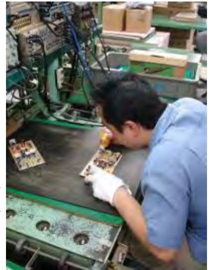
修理作業の様子。20年以上前の製品でも修理が可能
